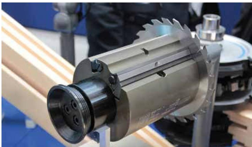
Az Integrál szerszámoknál egy munkamenetben a barázdaprofil és a finish
