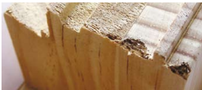
Keresztmetszeti megmunkálás hagyományos szerszámmal: kontra-profil tipikus kiszakadásokkal az egyenes él miatt
