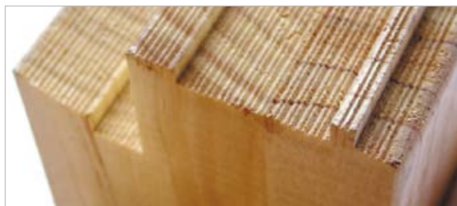
Keresztmetszeti megmunkálás a barzdaprofilos technológiával: kontra-profil kiszakadás nélkül. A barzdaák növelik a a ragasztási felületet
